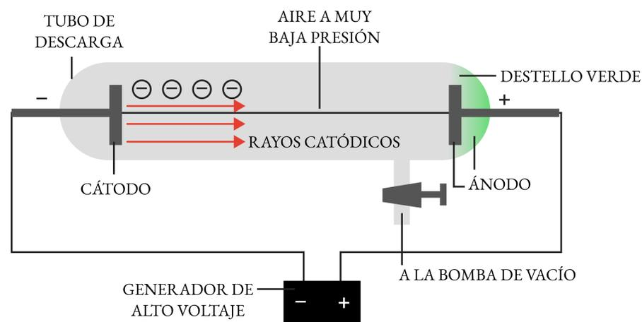
Thomson aplicó un alto voltaje a los electrodos de un tubo de descarga que contenía gas a baja presión.
