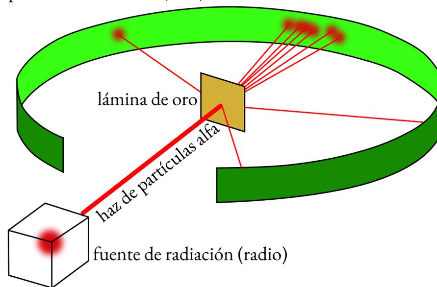
**Experimento de Geiger-Marsden.** Las partículas alfa ( $\alpha$ ), procedentes de radio (Ra) radiactivo y con carga positiva, se aceleran y se hacen incidir sobre una lámina de oro muy delgada. Tras atravesar la lámina, las partículas  $\alpha$  chocan contra una pantalla fluorescente (ZnS), produciéndose un destello. Traducida y adaptada de [https://commons.wikimedia.org/wiki/File:Geiger-Marsden\\_experiment.svg](https://commons.wikimedia.org/wiki/File:Geiger-Marsden_experiment.svg).
