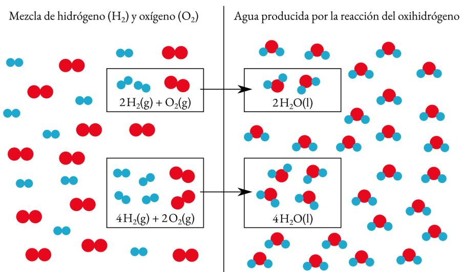
LEY DE LAS PROPORCIONES DEFINIDAS basada en la combustión de hidrógeno en oxígeno (reacción del oxihidrógeno). El hidrógeno y el oxígeno siempre reaccionan en una proporción 2:1. Se producen tantas moléculas de agua como moléculas de hidrógeno reaccionan.
