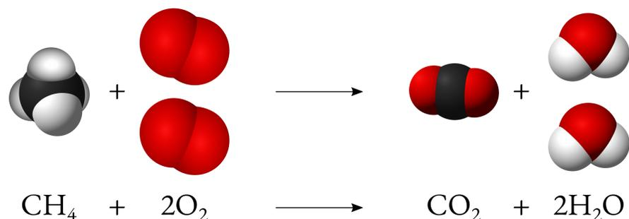
Reacción de COMBUSTIÓN del METANO, donde cuatro átomos de hidrógeno, cuatro átomos de oxígeno y uno de carbono están presentes antes y después de la reacción. La masa total después de la reacción es la misma que antes de la reacción. Adaptada de
